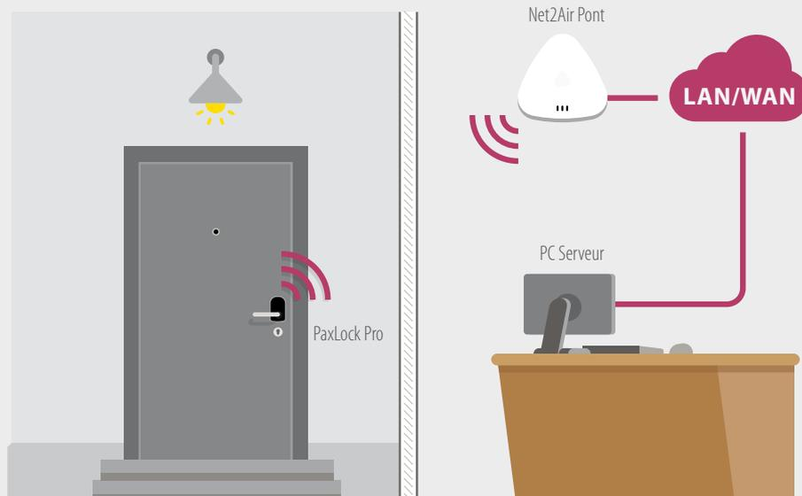
Exemple de PaxLock Pro avec un système Net2
