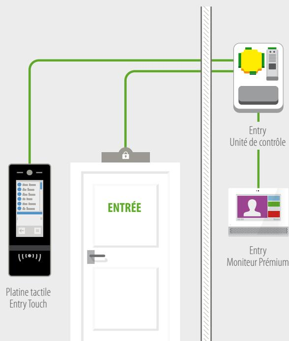
Un système autonome Entry n'a besoin ni de connexion à un réseau ni à un serveur
